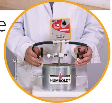
El procedimiento de calibración de áridos en el laboratorio implica el análisis eléctrico de una muestra representativa del suelo o de los áridos de construcción mientras se aplica el Método de Ensayo Normalizado para la Compactación en Laboratorio de la Norma ASTM D1557 utilizando una Energía Modificada de 56 000 pie-lbf/pie cúbico o el Método de Ensayo Normalizado para la Compactación en Laboratorio de la norma ASTM D698 utilizando una Energía Estándar de 12 000 ft-lbf/pie cúbico.
